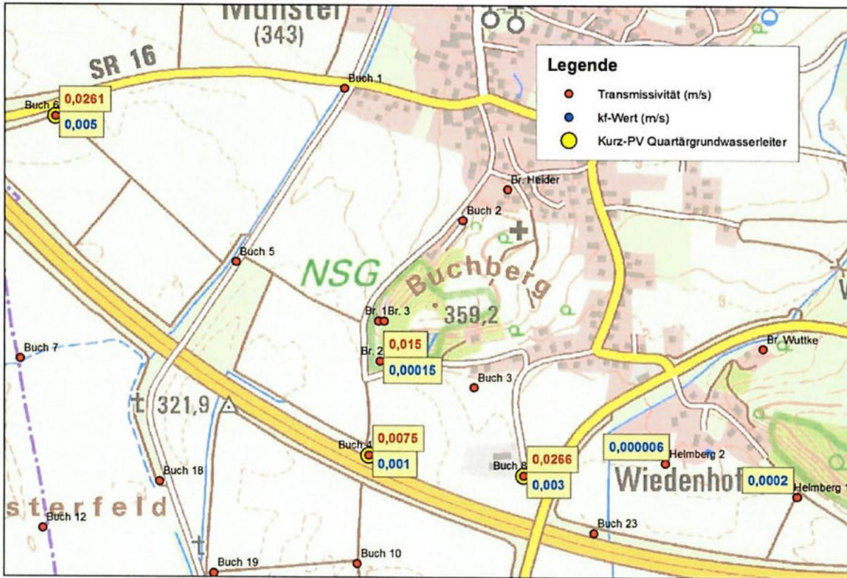
Abbildung 20: Lageplan mit  $k_f$ -Werten aus PV-Versuchen
