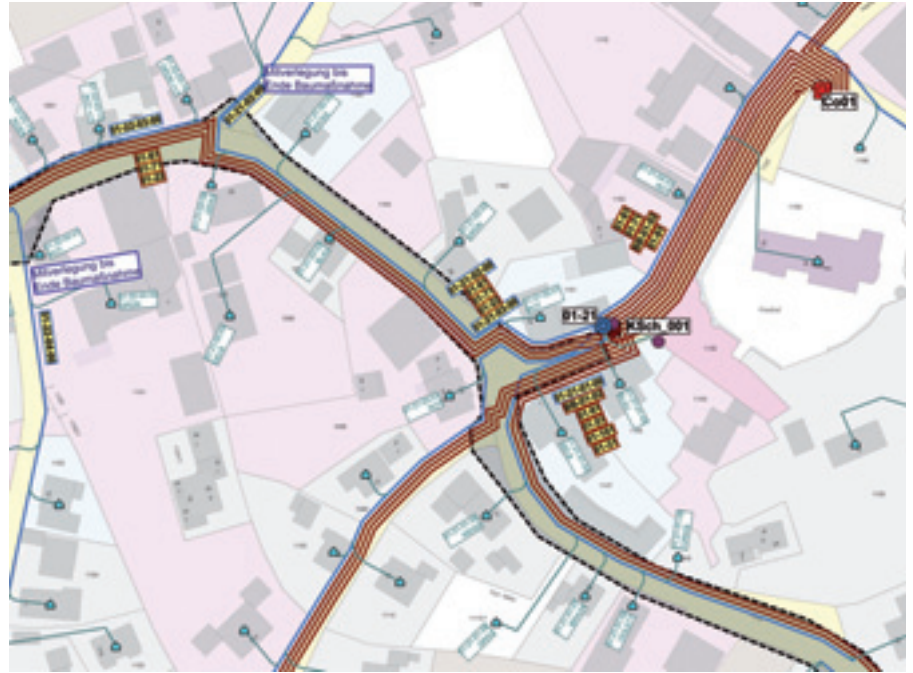
Auszug aus dem Glasfaser - Leerrohrplan August-Schmieder-Straße
