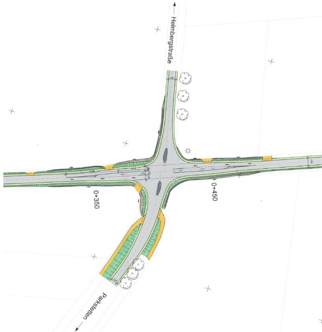
Abbildung 10: Lageplan Grundgeometrie für Signalisierung (Gemeinde Steinach)
